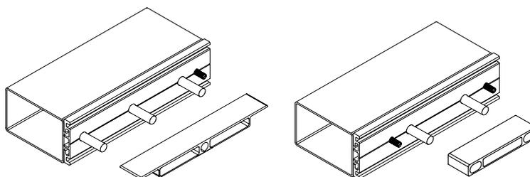
**Support de vitrage pour goujon  $\varnothing$  8 mm (pour 26 mm d'épaisseur de vitrage max.)**
