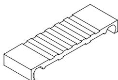
**Vissage de la partie basse dans la gorge de vissage vitrage vertical**
