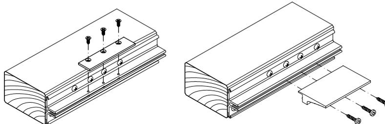
Support de vitrage en alu pour Stabalux AK; pour vitrage de 20 à 60 mm d'épaisseur
