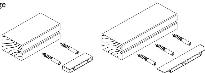
Support de vitrage pour vis à collier et goujons  $\varnothing$  10 mm, pour vitrage de 54 mm max.
